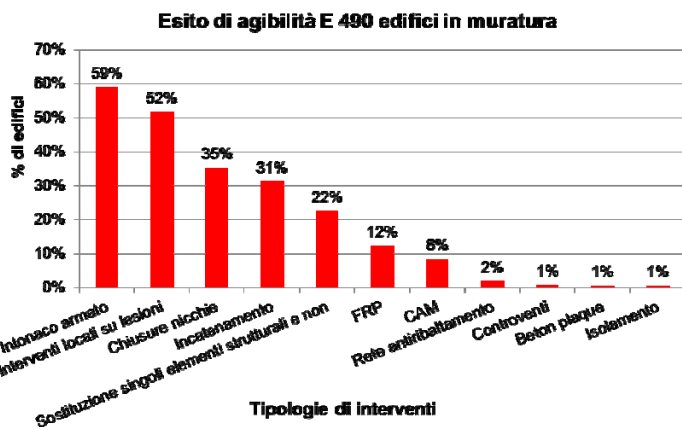
Figura 10 Interventi di miglioramento sismico (Edifici con danni severi - Esito E): edifici in c.a. (a); edifici in muratura (b).
